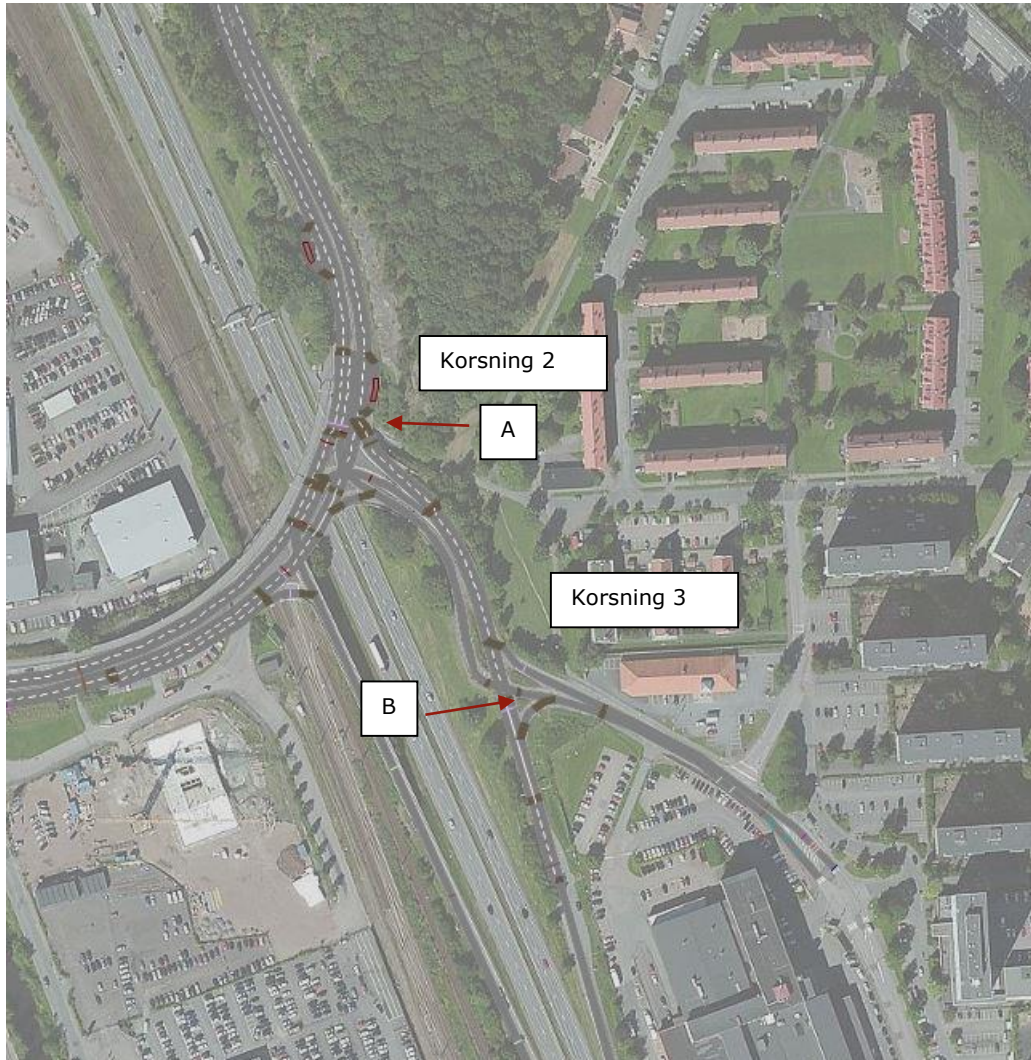
Figur 8. Översikt Alternativ 3. A: Två körfält åt höger mot väg 40 och B: Trafiksignalen i korsning 3 tas bort och trafiken från väg 40 mot Mejerigatan går under tunnel.
